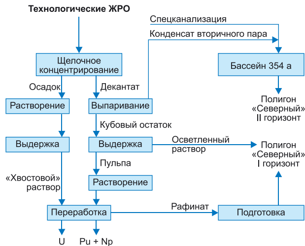
Рис. 1. Принципиальная схема обращения с технологическими ЖРО
