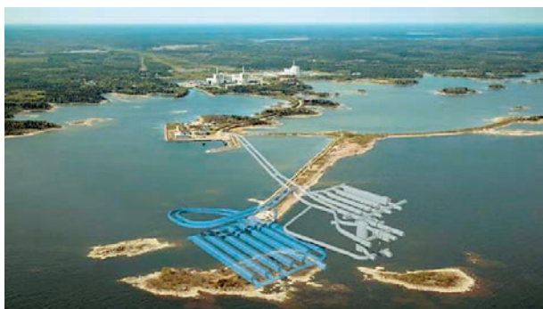
Рис. 4. Пункт захоронения SFR (Форсмарк): серым цветом показаны уже сооруженные выработки, синим — планируемые к сооружению
