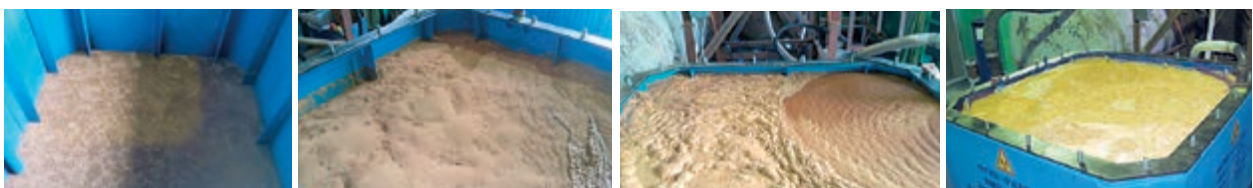
Рис. 3. Заполнение контейнера пульпой и обезвоживание ИОС
