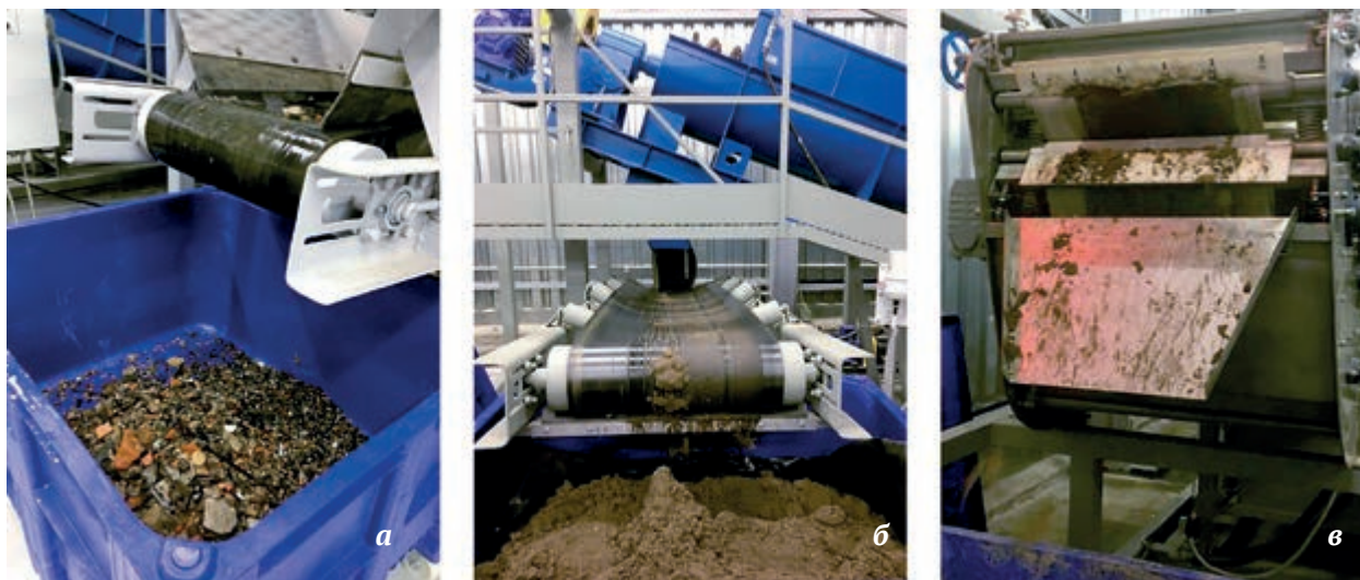
Рис. 1. Выгрузка продуктов переработки: а) из модуля скруббера фракции с размером частиц более 3 мм; б) из модуля классификатора фракции с размером частиц 0,15–3 мм; в) из модуля фильтр-пресса фракции с размером частиц менее 0,15 мм
