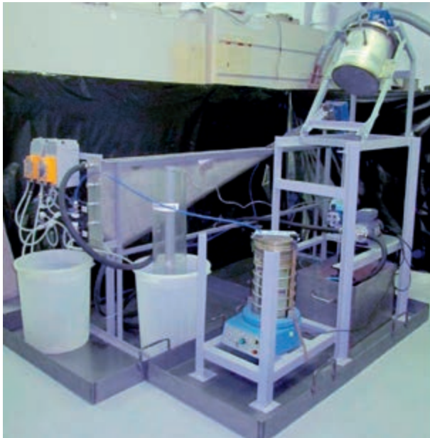
Рис. 2. Лабораторный стенд очистки РЗГ методом гидросепарации
