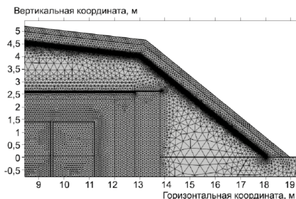
Рис. 6. Разбиение модели на расчетные ячейки (фрагмент)
