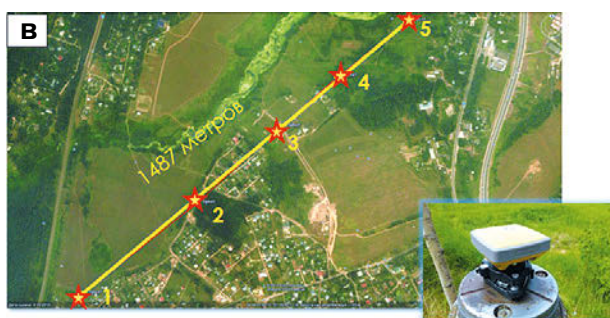
Рис. 4. Вертикальный профиль эталонного базиса (а), измеренные во всех комбинациях фрагменты базиса (б) и карта его расположения (в). Звезды – пункты установки аппаратуры
