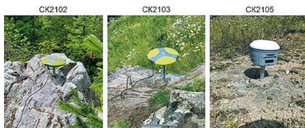
Рис. 3. Общий вид скальных геодезических центров во время выполнения ГНСС-измерений на геодинамическом полигоне Нижнеканского массива
