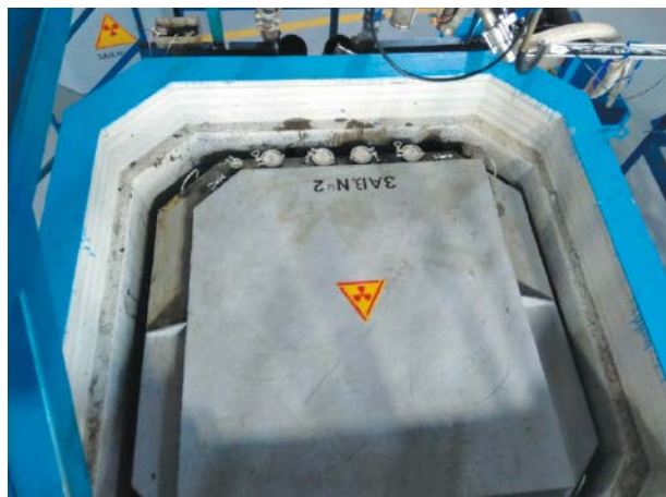
Рис. 2. Внешний вид контейнера НЗК-150-1,5П со вставкой с ОИОС Калининской АЭС после пропитки
