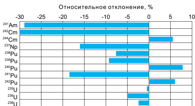
Рис. 2. Относительное отклонение расчетного накопления актинидов от данных JAEA в БВ энергоблока 1 на момент начала аварии
