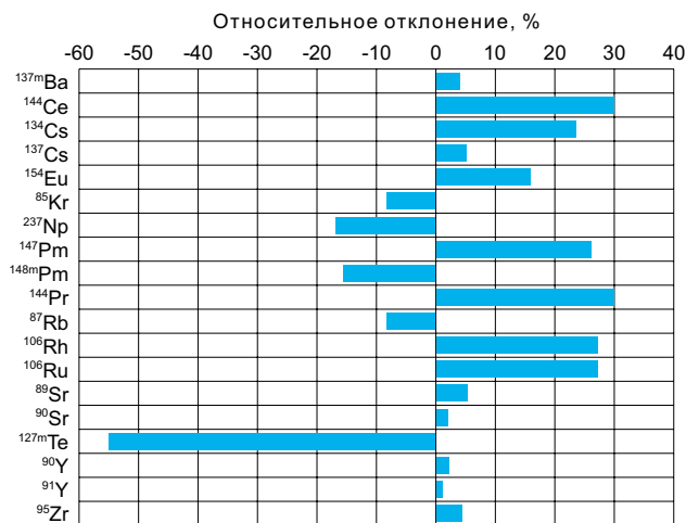
Рис. 3. Относительное отклонение расчетного накопления продуктов деления от данных JAEA в БВ энергоблока 1 через 10 лет после аварии
