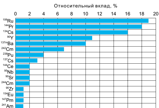
Рис. 6. Относительный вклад радионуклидов в мощность ОТВ в БВ энергоблока 1 в начале аварии (по данным JAEA)
